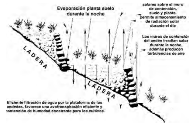
El andén y su funcionamiento para minimizar los riesgos de las heladas en ecología andina
